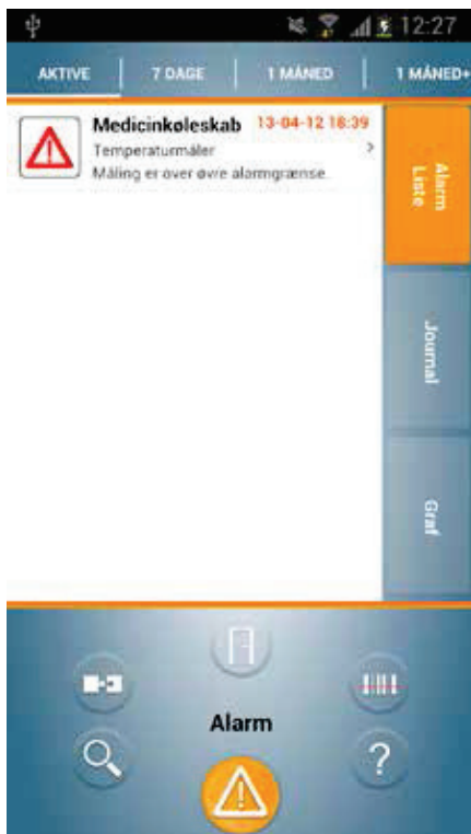
Opstart af App'en sker altid med at vise, hvis der er alarmer – hvis der ikke vises nogen alarmer, er alt som det skal være
